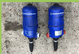
Pompe doseuse pour injection du biostimulant dans le système d'irrigation
